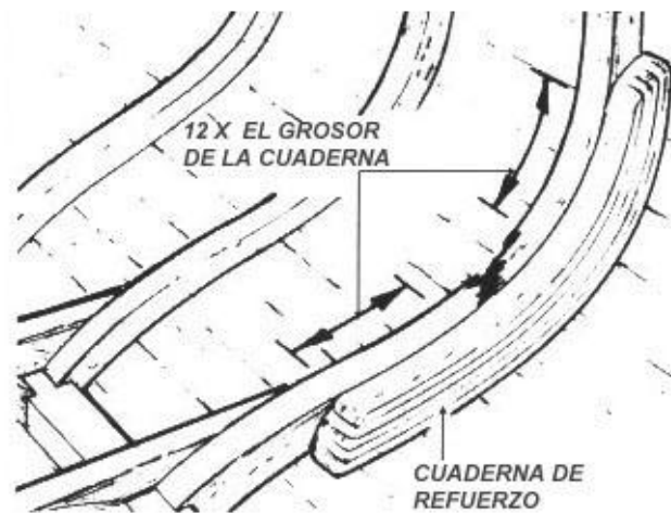
Figura 5-6 Lamine una cuaderna doble parcial más larga que el área dañada
