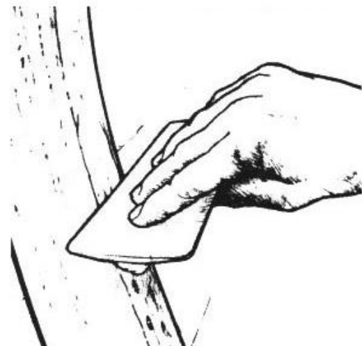
Figura 4-5 Rellene los huecos que queden con masilla de modelar.
