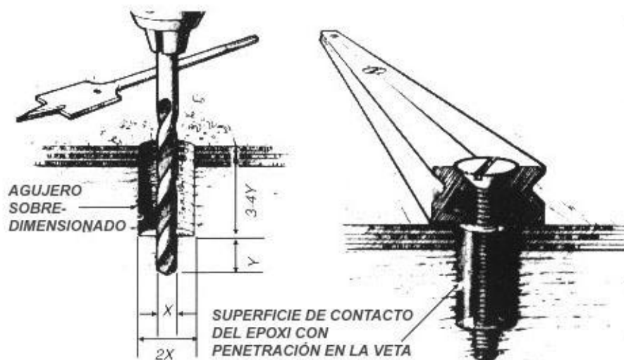
Figura 7-1 Un agujero guía de tamaño normal al fondo de un agujero sobredimensionado proporcionará una presión de sujeción suficiente para mantener al accesorio en posición mientras el epoxi cura.
