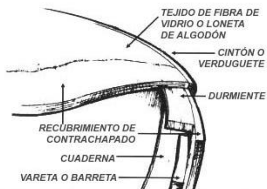
Figura 2.3 Construcción típica con contrachapado
