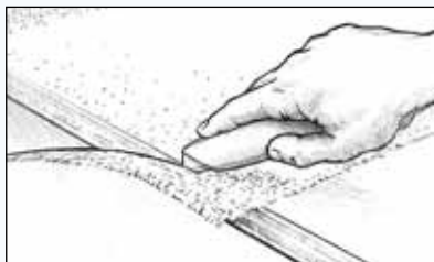
Figura 25 Recorte la tela sobrante después de que el epoxi se haya gelificado pero antes de que se endurezca.
