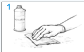
Figura 6 Limpie la superficie. Utilice un disolvente, si es necesario, para eliminar todo contaminante.
