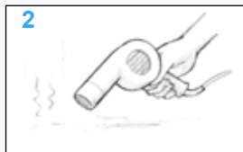
Figura 7 Seque la superficie. Deje que se sequen totalmente las superficies mojadas, o utilice calor o un ventilador para acelerar el secado.
