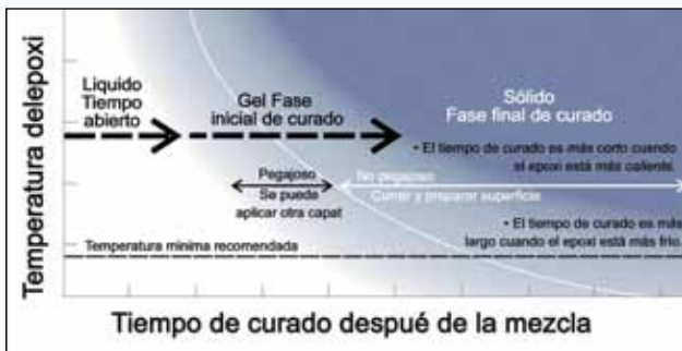
Figura 1 Al curarse, el epoxi mezclado pasa de un estado líquido a través de un estado gelatinoso a un estado sólido.
